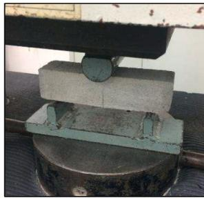
(d) three-point bending test
